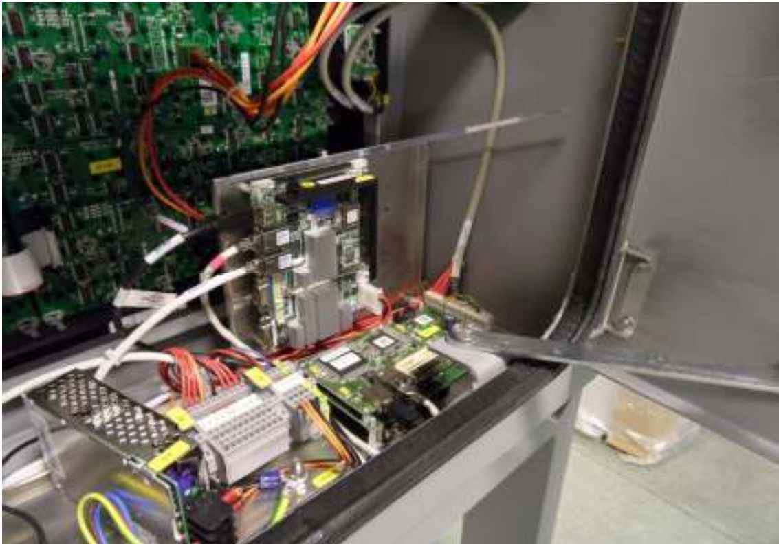
9. ábra: A táblák házának sarkában kapott helyett a beépített számítógép
