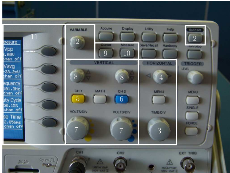
5. ábra. Az oszcilloszkóp legfontosabb kezelőszervei
