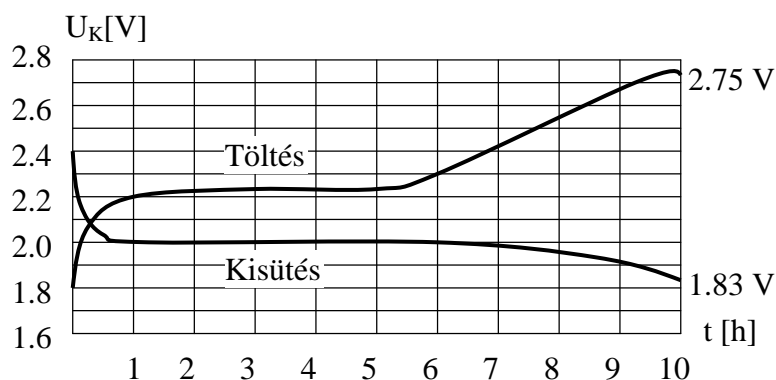
3.1.1 ábra Savas akkumulátor feszültségének változása töltés és kisütés folyamán
