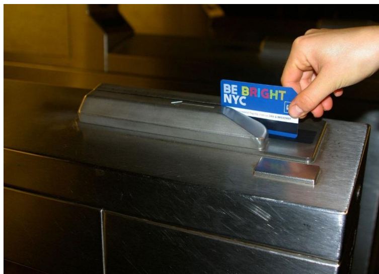
5. ábra: Mágnes csíkos kártya és a hozzá tartozó érvényesítő berendezés
