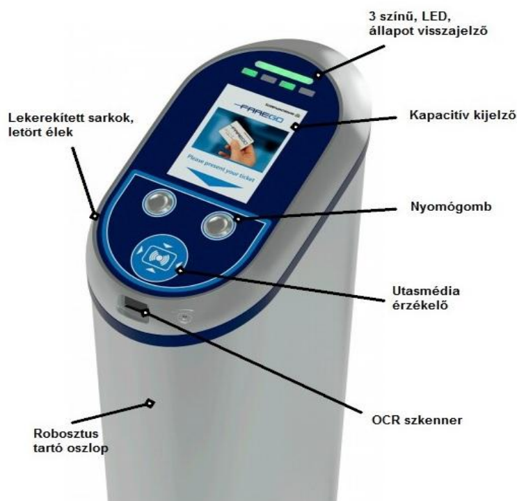
13. ábra: Peroni érvényesítő berendezés (Forrás: http://www.scheidt-bachmann.com )
